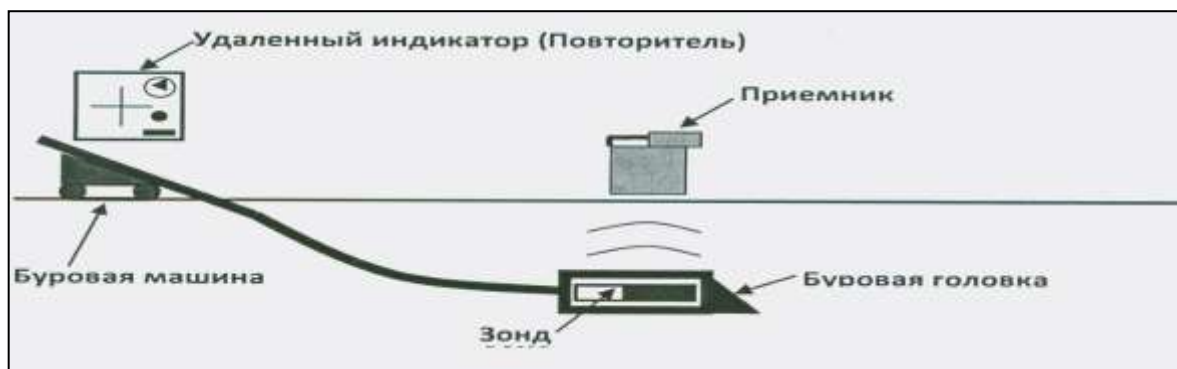
Рисунок В.2 – Схема действия электромагнитной системы подземной локации
