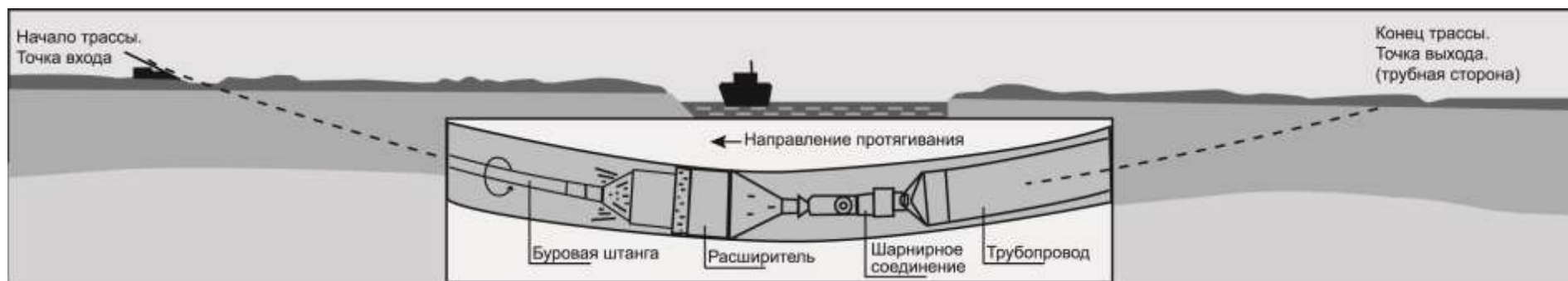
Рисунок 8.6– Сборка буровой колонны для протягивания трубопровода
